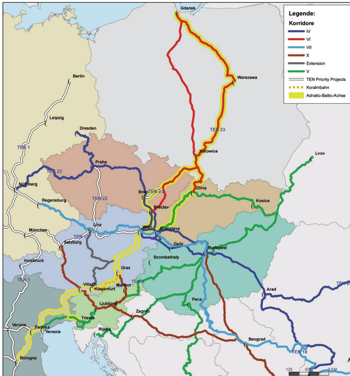
Abbildung 2: Bestehende TEN-Achse 23 und geplante Verlängerung der TEN-Achse 23 (Baltisch-Adriatische Achse) (Quelle: [4], eigene Ergänzung)
