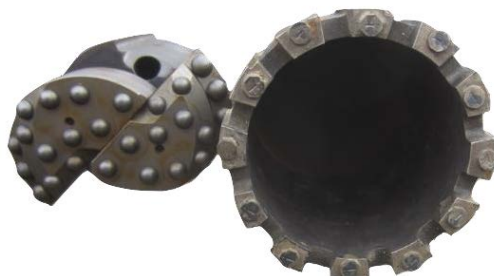
Abbildung 2. Beispiel Hammerkrone Exzentrisch und Ringbohrkrone Neu mit Knickrohr.
