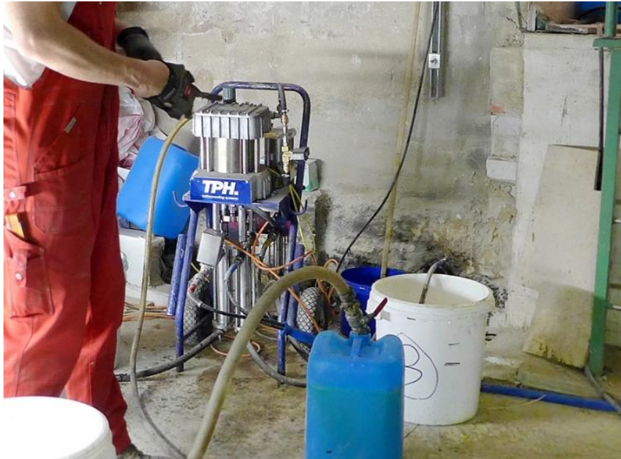
Abbildung 2. Pneumatisch betriebene Zweikomponenten-Kolbenpumpe. (Quelle: TPH)
