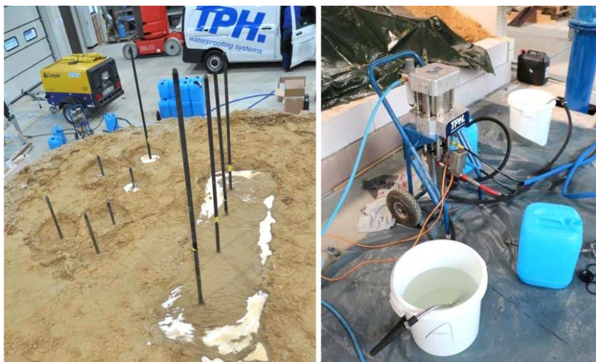
Abbildung 5. Versuchsaufbau mit unterschiedlichen Lanzenanordnungen im Versuchsfeld.
